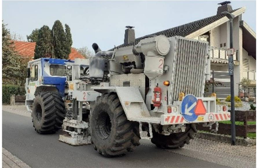
Vibrationsfahrzeuge eingesetzt, die Schallwellen erzeugen. Alle 50 Meter hält das Fahrzeug an und vibriert für gut eine Minute. Die vom Vibrationsfahrzeug erzeugten Schallwellen werden von gezielt ausgelegten Geophonen, also kleinen grauen Kästen am Boden, aufgezeichnet.
